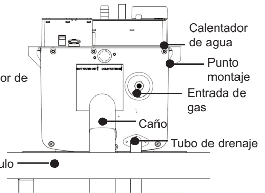
Fig. 33 Instalación finalizada - Modelos de interior
